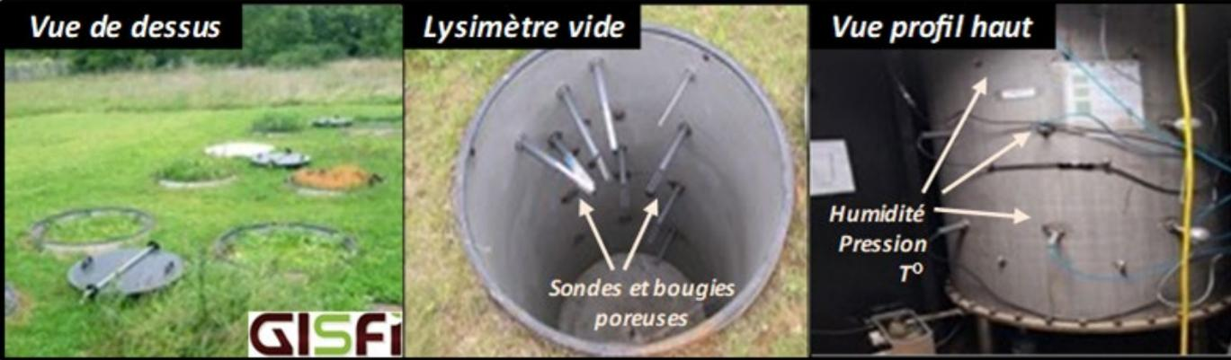
Exemple de colonnes Lysimétriques : Station expérimentale du GISFI
