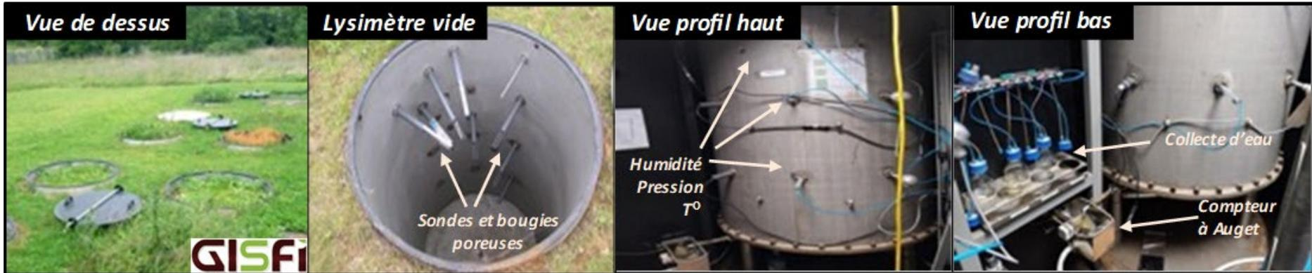
Exemple de colonnes Lysimétriques : Station expérimentale du GISFI
